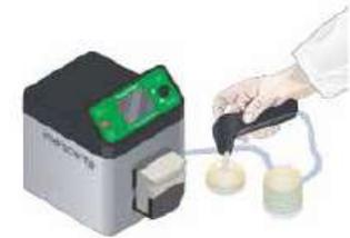
Prepare su medio de cultivo (en tubos de ensayos, frascos, placas de Petri...) para una siembra óptima de su muestra con **FlexiPump®**.
