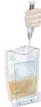
Pipetee el filtrado con **BagPipet®**. La filtración es instantánea y estéril. La muestra filtrada está lista para la siembra y el análisis.
