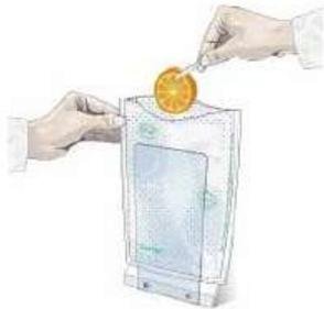
Coloque la muestra en una bolsa estéril **BagPage®** o **BagFilter®**.
